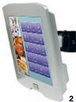
1-2| Im Hygrolion, einem Industrie-PC von ICO können keine Stäube, Schmutz, Emulsionen, Aerosole und Wasser ins Gehäuse gelangen.
